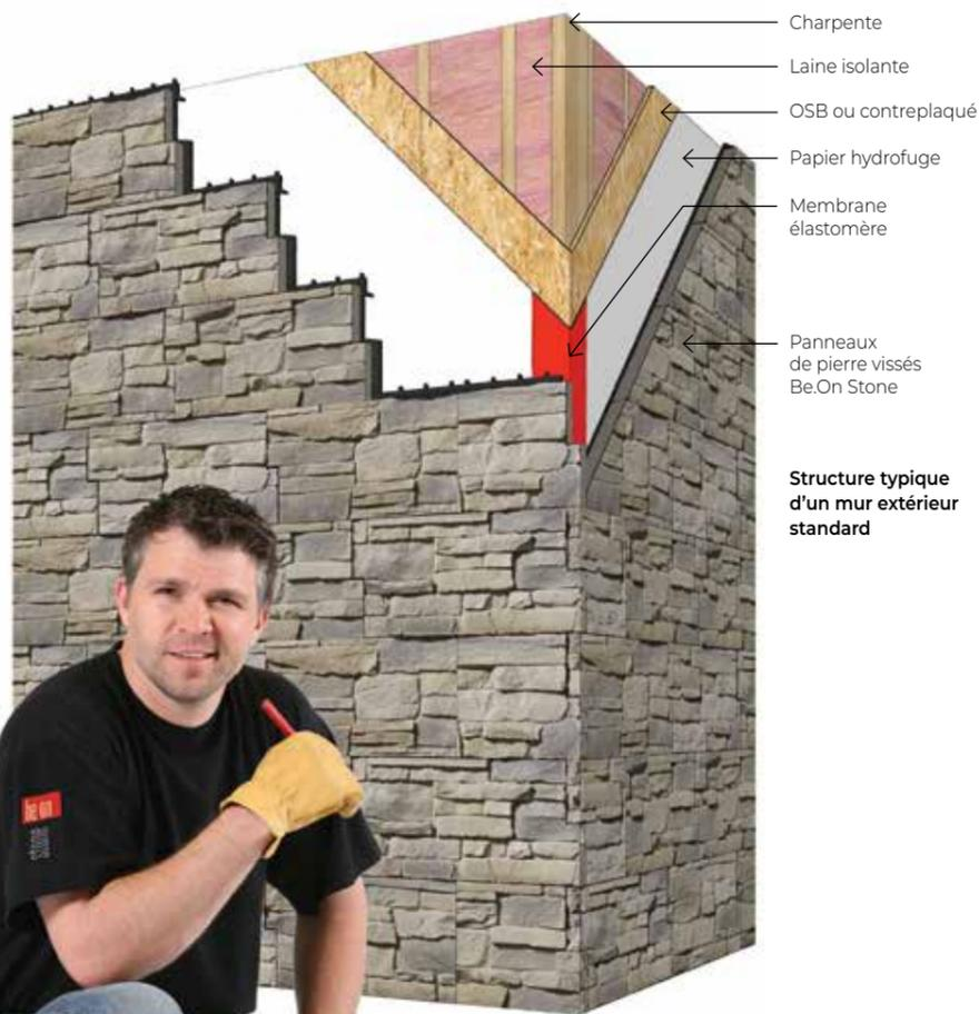
Structure typique d'un mur extérieur standard
